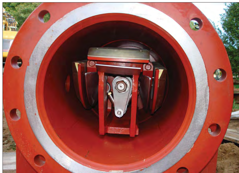
Bild 3. Abdichtkopf im Stopple-Gerät vor der Montage
